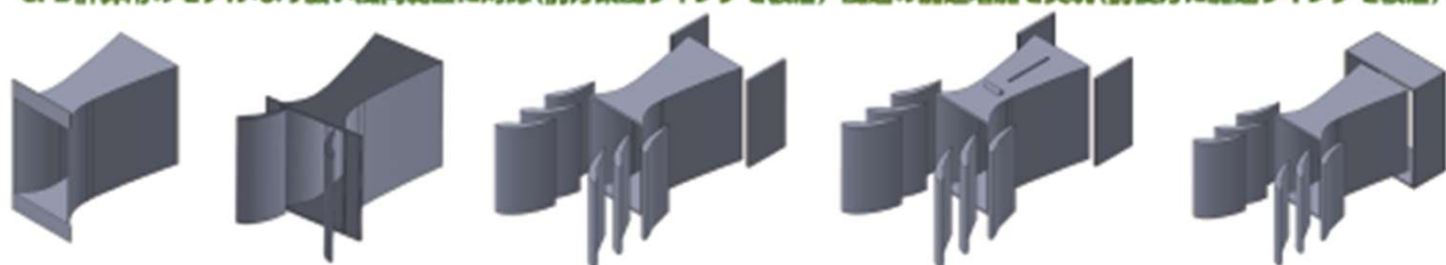
CFD計算用のモデル:より広い風向範囲に対応(前方集風ウイングを装着)・風速の加速増加を実現(前後方に加速ウイングを装着)
